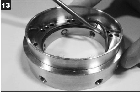
13 Déposez le joint torique (Y) de la bague de verrouillage et mettez-le au rebut.
